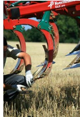
**Economico** ...La doppia forma conica evita alle parti intercambiabili di perdersi poiché durante il lavoro la pressione del suolo combinata alla velocità di avanzamento aumentano sempre più il serraggio. Il supporto è protetto da una bombatura in fusione perciò prima della sua sostituzione dovranno essere utilizzate diverse serie di punte. Questo determina ovviamente un risparmio economico notevole.
