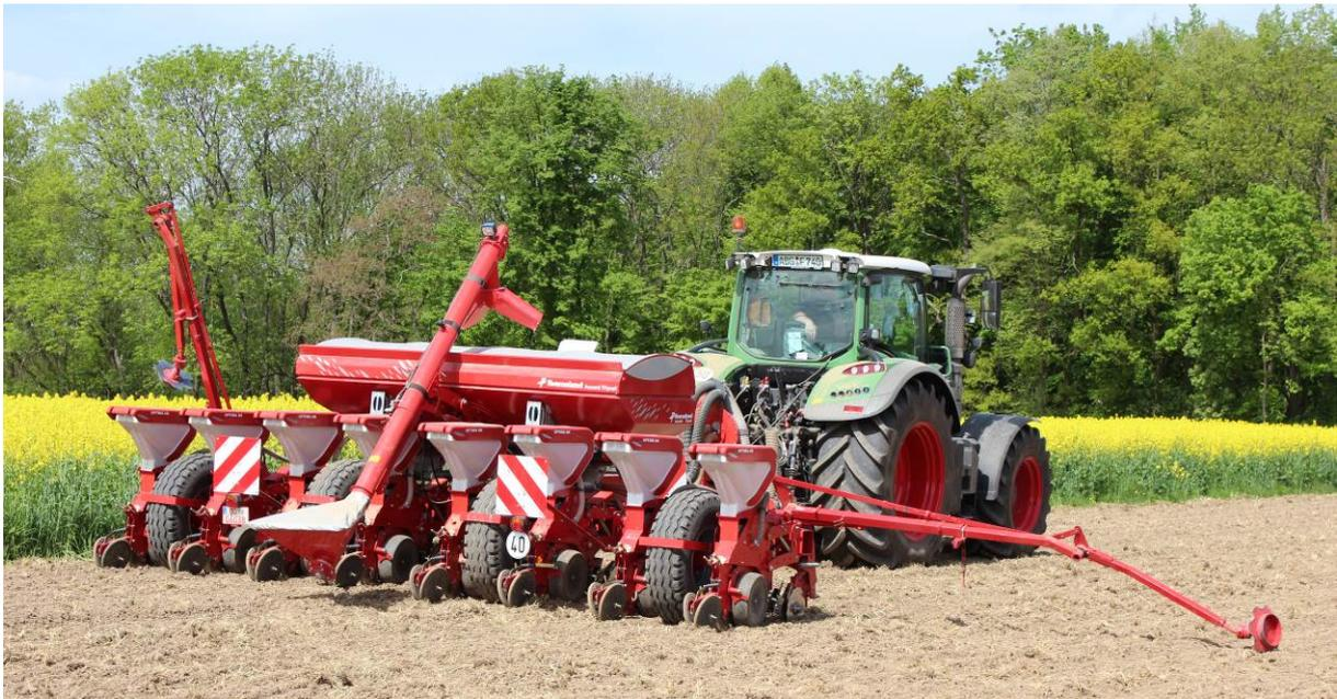
Sarà disponibile anche nella versione a 4 pneumatici (opzionali) e dotata di un nuovo sistema di ammortizzazione idraulico che consente di seguire perfettamente il terreno. La turbina di aspirazione è stata portata sulla parte anteriore del timone, facilmente accessibile quindi per eventuali manutenzioni.
